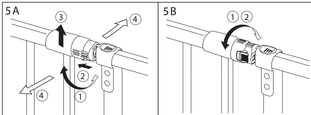
**Nota:** verifique la instalación correcta de la puerta abriéndola parcialmente y soltándola varias veces. La puerta se cerrará y se enganchará doblemente en forma automática. Verifique regularmente las perillas de tensión y las almohadillas de goma para asegurarse de que la puerta esté colocada firmemente en su lugar
