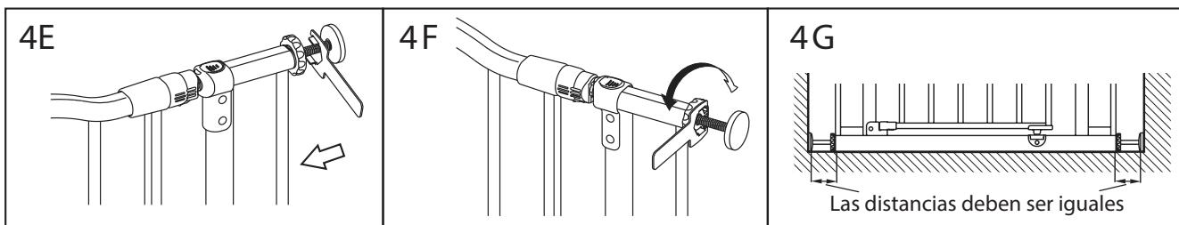
**Nota:** al ajustar, la distancia entre los 4 pernos de tensión debe ser igual, como se muestra en la Figura 4G.
