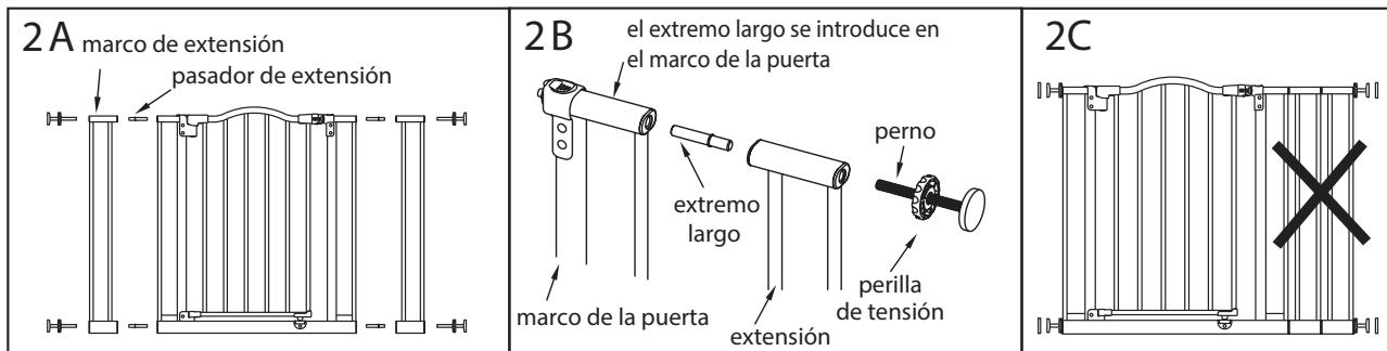
**IMPORTANTE:** no instale dos extensiones en el mismo lado de la puerta, como se muestra en la figura 2C.
